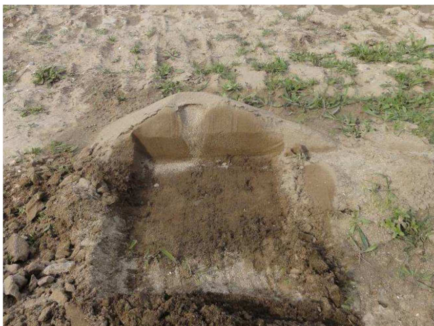
Figure 7-2 : Coupe d'un « sand-boil » derrière les digues de l'Agly - crue du 6 mars 2013 (photo : DDT des Pyrénées-Orientales)
