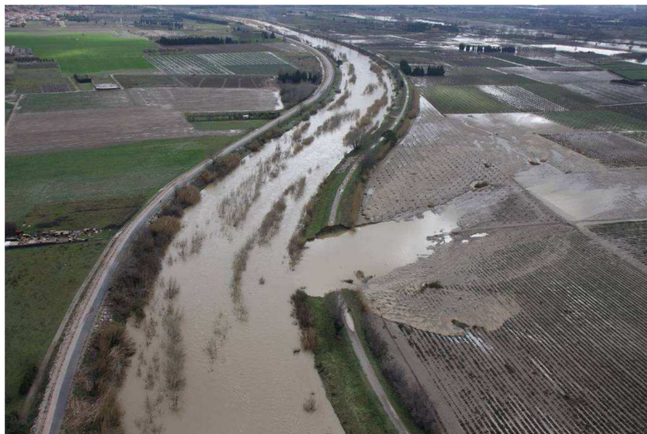
Figure 7-1 : Brèche de Pia sur l'Agly - crue du 6 mars 2013 (photo : protection civile des Pyrénées-Orientales)
