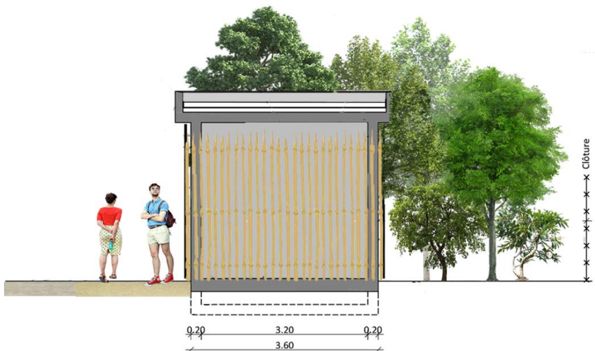
Figure 7 : habillage des locaux électriques par panneaux de ganivelles
